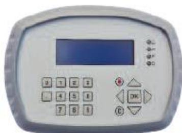
Panneau de commande à affichage LCD "EASY" monté en façade de la centrale **NEOTIME®** pour réglage horloges, débits, température (gestion proportionnelle du bypass interne, de la batterie chaude pour les versions **BC** ou électrique pour les versions **BE**, surventilation nocturne), contrôle et lecture défaut(s)...
